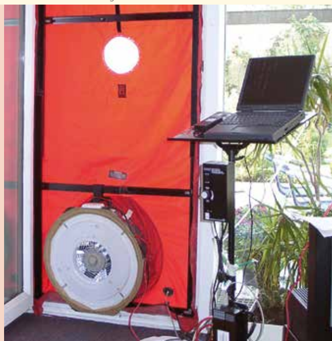
Ventilator zur Durchführung eines Drucktests
