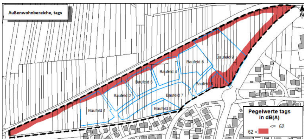
Abbildung 15 – Kennzeichnung Schutz der Außenwohnbereiche (dunkelrot: Pegelwerte tags > 62 dB(A)), Rechenhöhe 4 m ü. Gel.
