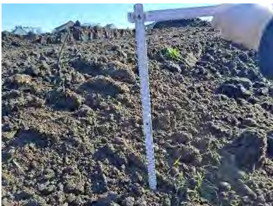
Abb. 25: Einbaumächtigkeit (ungesiebt Material) von > 30 cm als durchwurzelbare Schicht
