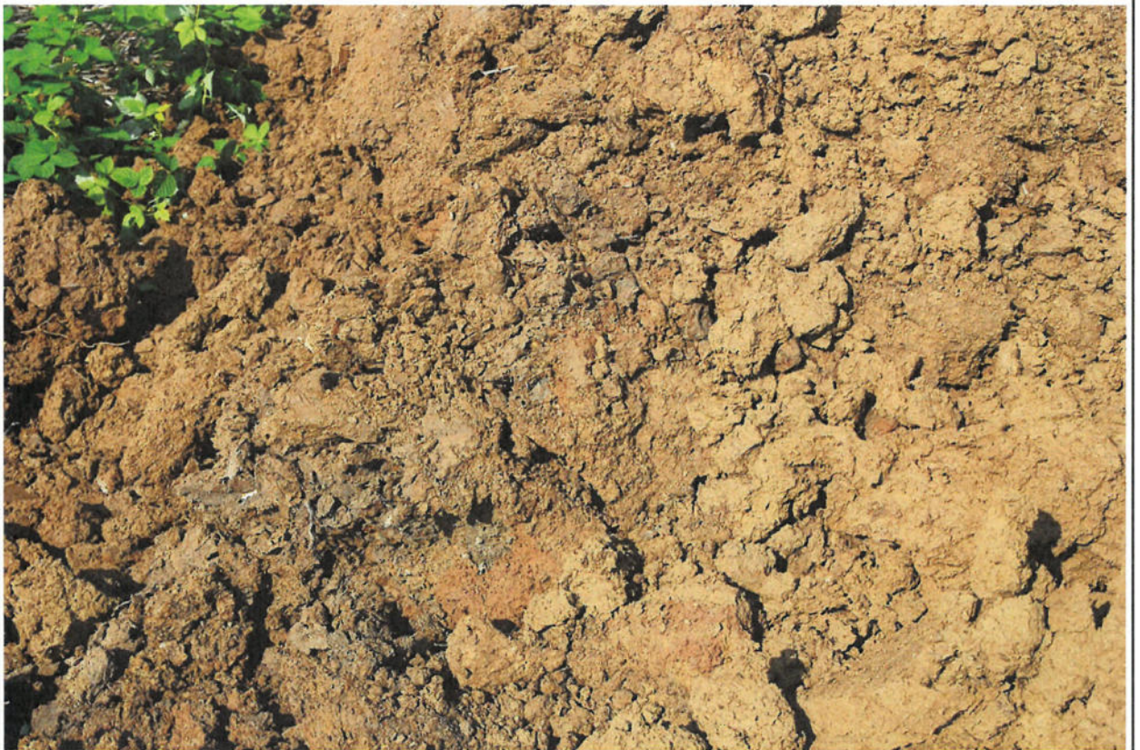
Bild 2: Aushub von Schurf S1 (Auffüllungen)
