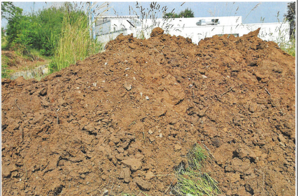
Bild 8: Aushub von Schurf S4 (Auffüllungen)
