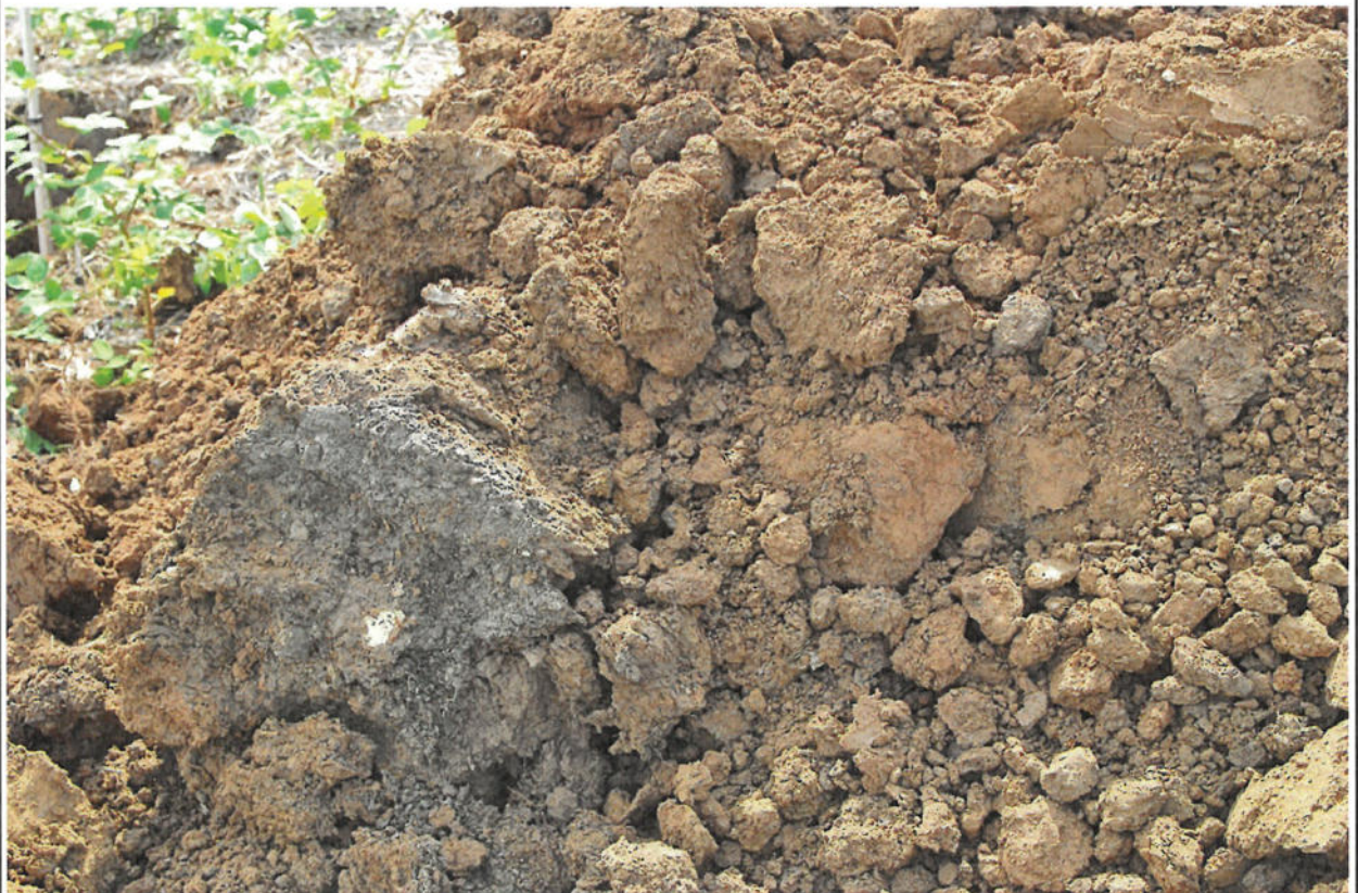
Bild 6: Aushub von Schurf S3 (Auffüllungen)
