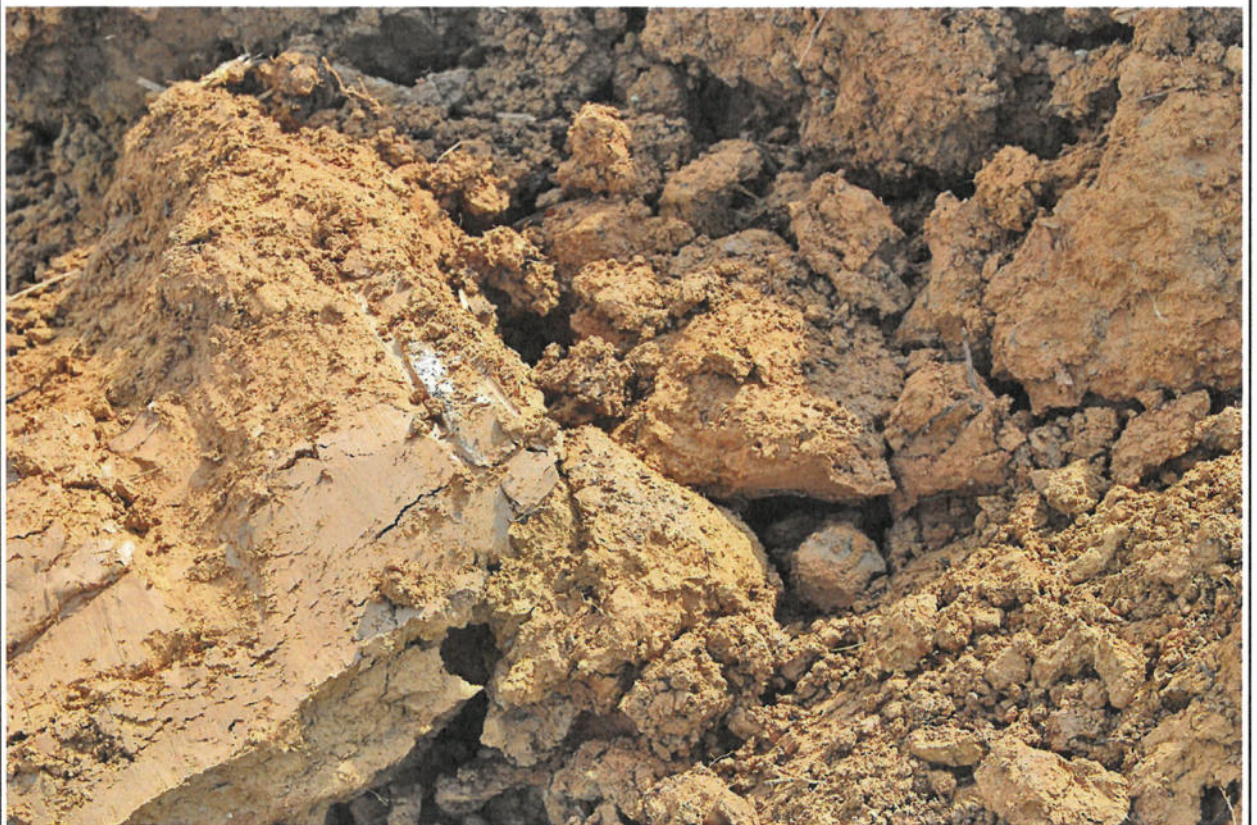
Bild 4: Aushub von Schurf S2 (Auffüllungen)
