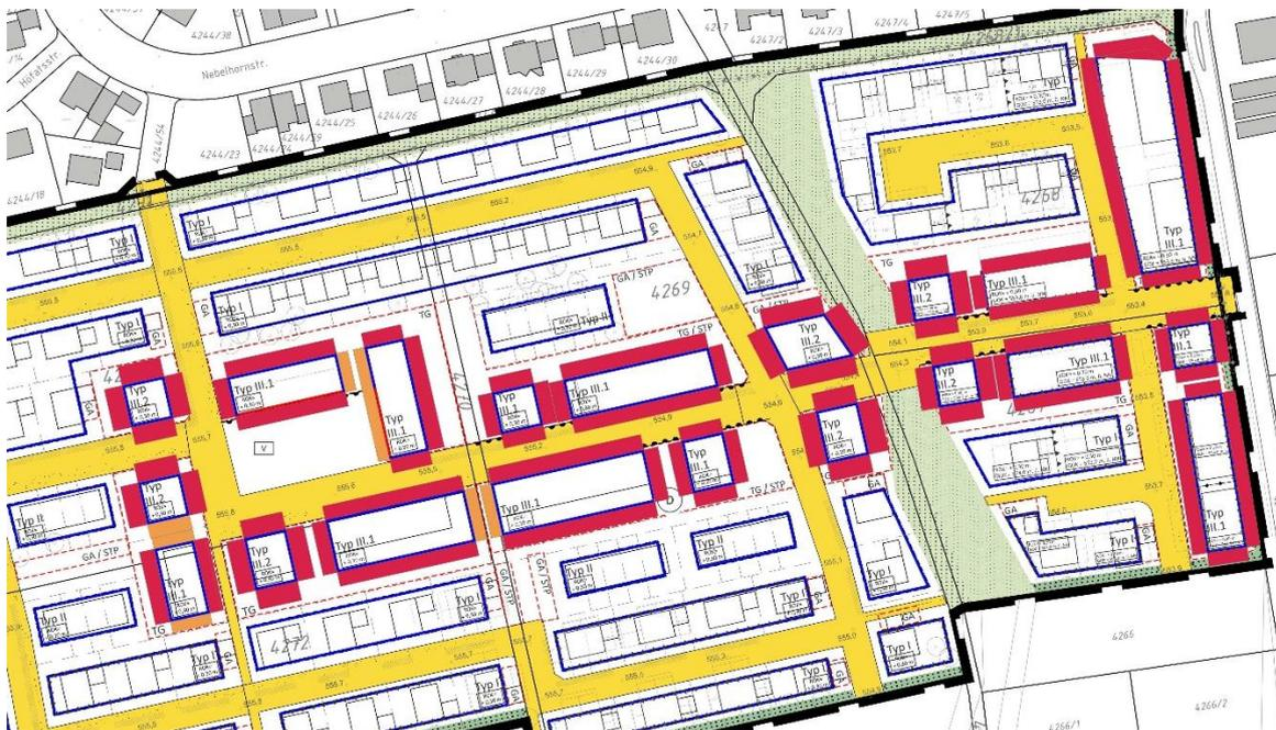
Abbildung 5: Bei maximal ausgenutzten Baufenstern sowie Wand- und Dachhöhen der Gebäudetypen III.1 und III.2 können Abstandsflächen von mind. 0,5 H (rot eingefärbt) bzw. 0,4 H (orange eingefärbt) eingehalten werden.
