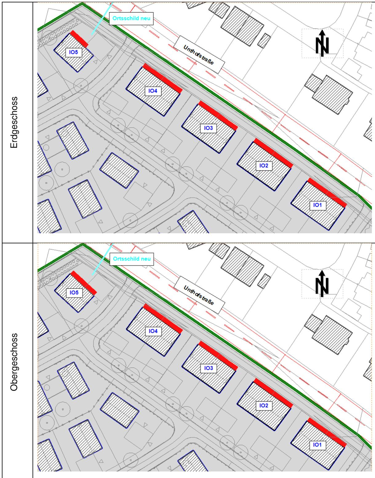
Abbildung 11: Fassadenkennzeichnung für schutzbedürftige Aufenthaltsräume, die überwiegend zum Schlafen genutzt werden
