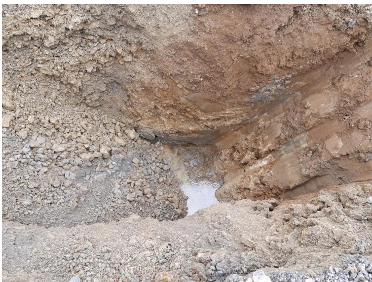
Abbildung 4 Erkundungsschurf: Mineralölverunreinigtes Bodenmaterial/ Schichtwasser mit aufschwimmender Ölphase
