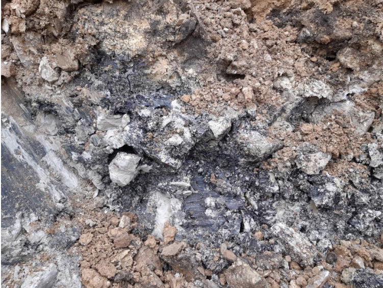
Abbildung 7 Schwerölkontaminationen im Gestein/ Bodenmaterial
