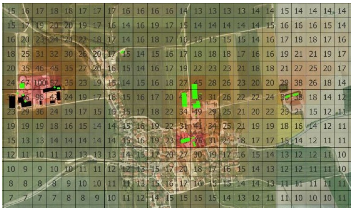
Geruchshäufigkeit in % der Jahresstunden - Ausschnitt aus der Geruchsausbreitungsberechnung von 2019
