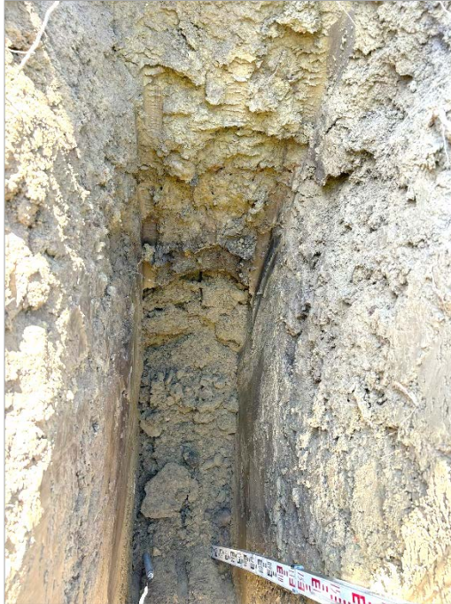
Foto 1: Sickerversuch 1/Schurf 1, westlich des bestehenden Feuerwehrgebäudes
