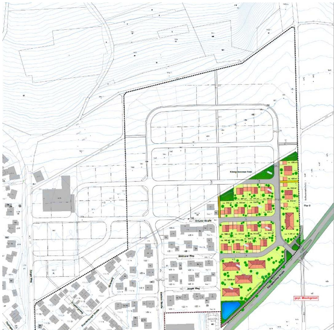
Abbildung 1. Baugebiet „Königsbronner Feld II“ - Bebauungskonzept (Stand 14.01.2020). Der Geltungsbereich des Bebauungsplans ist farbig hervorgehoben, die potentiellen Erweiterungsbereiche sind skizziert, Bestandsbebauung ist in grau dargestellt. Das große Gebäude links in der Mitte ist der Reitstall.
