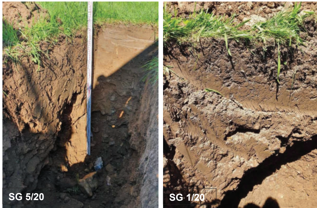
Abbildung 12: BK 1: Braunerde über Schmelzwasserkiesen (SG5 - SG1)
