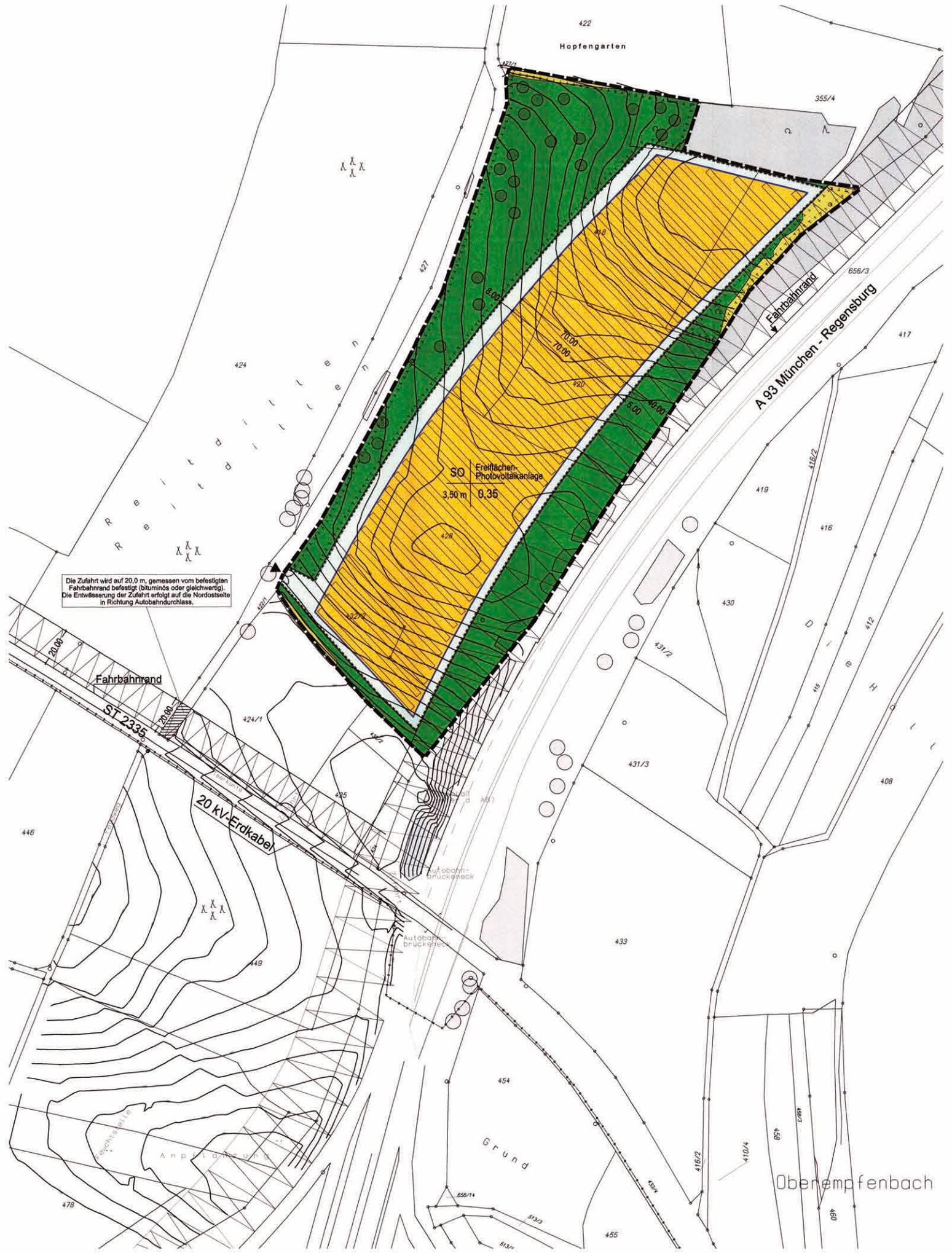
Die Zufahrt wird auf 20,0 m, gemessen vom befestigten Fahrbahnrand befestigt (bituminös oder gleichwertig). Die Entwässerung der Zufahrt erfolgt auf die Nordostseite in Richtung Autobahndurchlass.
