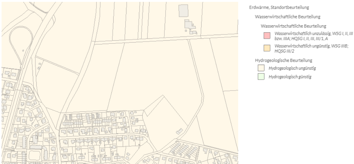
Abbildung 61: Eignung des Gebiets für Erdwärmesonden (HLNUG, 2017)
