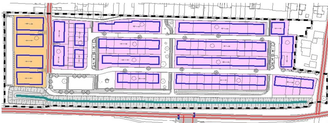
Auf der in der Planzeichnung mit „SM 1“ bezeichneten Fläche ist ein Erdwall mit einer aufgesetzten Schallschutzwand zu errichten. Die Schallschutzwand ist mit einer Mindesthöhe von 148,70 m über NN und einer Schalldämmung DL\_R von mindestens 25 dB nach DIN EN 1793-2:2019-05 umzusetzen.
