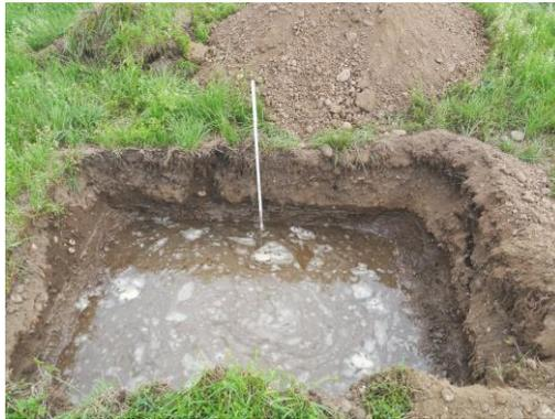
Abb.25: Versickerungsversuch im Baggerschurf 10/15
