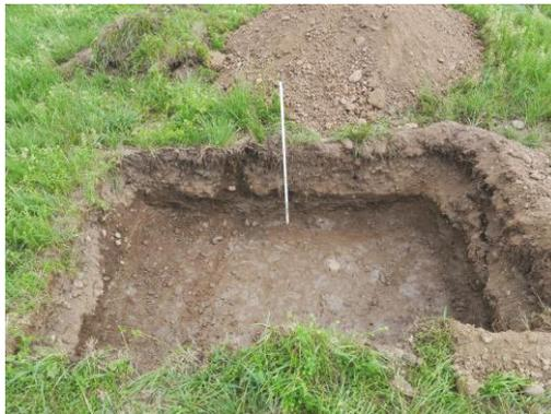
Abb.26: Versickerungsversuch im Baggerschurf 10/15
