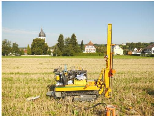
Abb.10: Schwere Rammsondierung am Ansatzpunkt DPH 4/15
