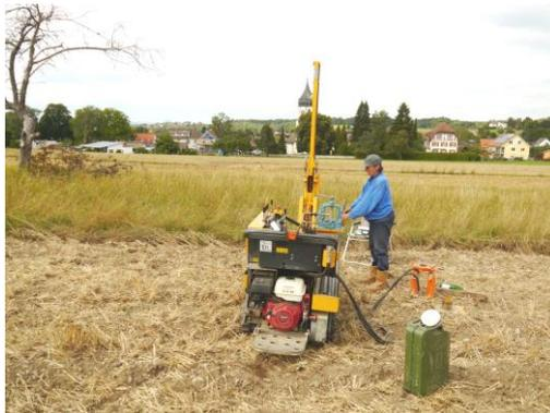
Abb.16: Schwere Rammsondierung am Ansatzpunkt DPH 7/15
