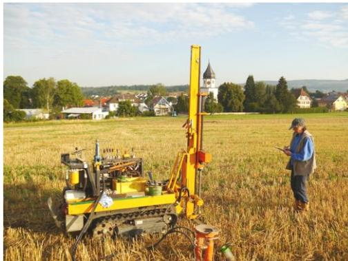
Abb.22: Schwere Rammsondierung am Ansatzpunkt DPH 10/15
