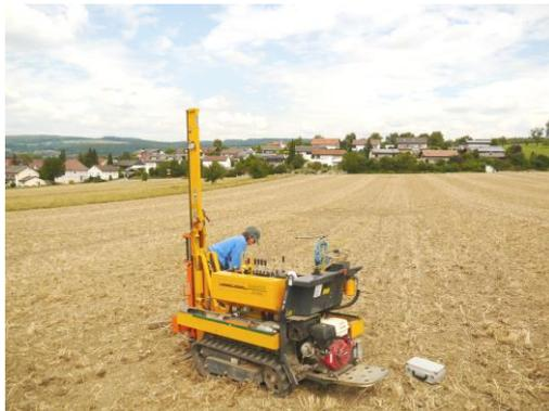
Abb.20: Schwere Rammsondierung am Ansatzpunkt DPH 9/15
