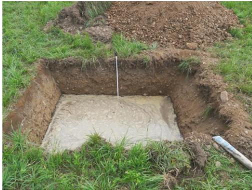
Abb.26: Versickerungsversuch im Baggerschurf 11/15
