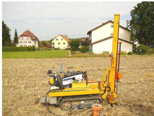
Abb.4: Schwere Rammsondierung am Ansatzpunkt DPH 1/15
