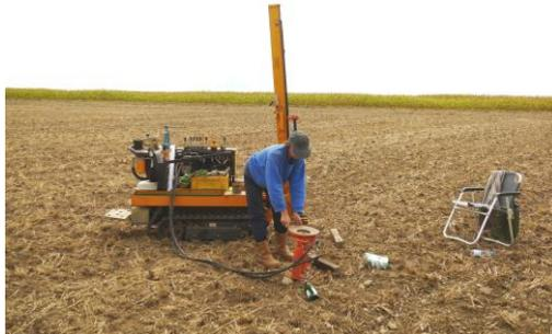
Abb.18: Schwere Rammsondierung am Ansatzpunkt DPH 8/15
