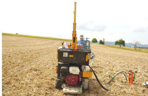
Abb.12: Schwere Rammsondierung am Ansatzpunkt DPH 5/15
