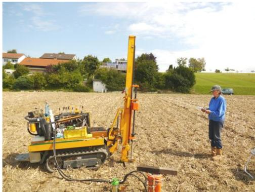
Abb.8: Schwere Rammsondierung am Ansatzpunkt DPH 3/15
