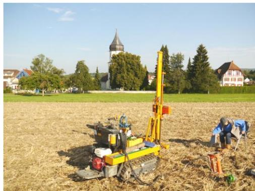
Abb.14: Schwere Rammsondierung am Ansatzpunkt DPH 6/15
