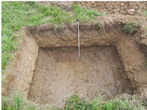
Abb.27: Versickerungsversuch im Baggerschurf 11/15
