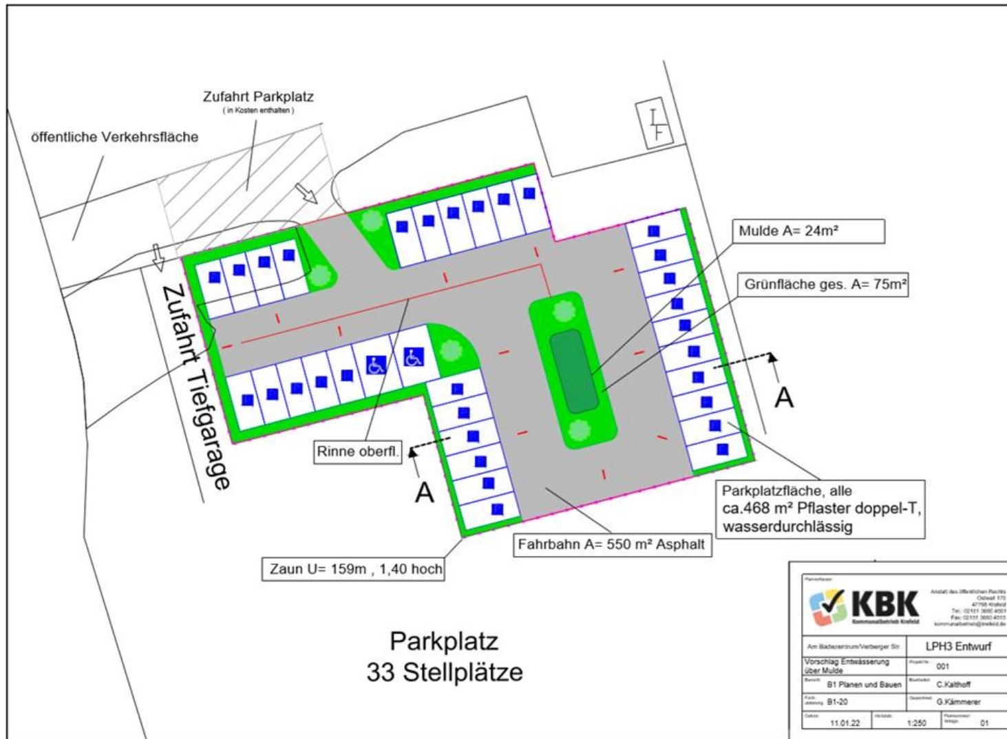
Abbildung Bauvorhaben Neubau Friedhofsparkplatz. Der Bebauungsplan Nr.806 (Entwicklung eines Wohngebietes in Krefeld-Bockum) sieht eine Neuordnung der vorhandenen Flächen vor und erfordert die Verlegung des jetzigen Friedhofsparkplatzes in Richtung Norden näher zur Trauerhalle – gemäß Abbildung.
