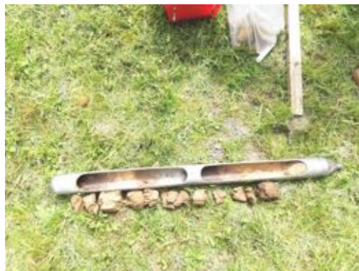
Abb.10: Rammkernsonde (1m) vom Ansatzpunkt RKS 3/21
