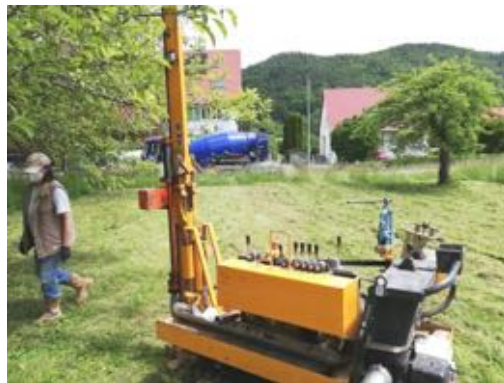
Abb.9: Rammkernsondierung am Ansatzpunkt RKS 3/21
