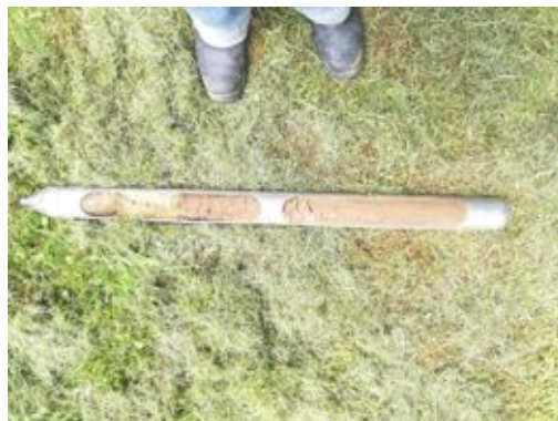
Abb.8: Rammkernsonde (1m) vom Ansatzpunkt RKS 2/21
