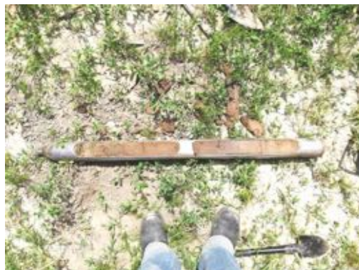
Abb.6: Rammkernsonde (1m) vom Ansatzpunkt RKS 1/21
