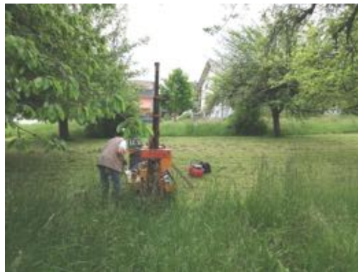
Abb.7: Rammkernsondierung am Ansatzpunkt RKS 2/21
