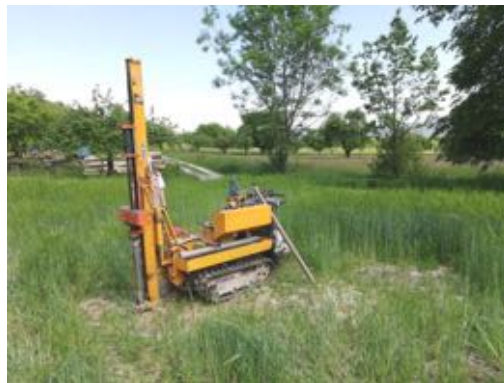
Abb.5: Rammkernsondierung am Ansatzpunkt RKS 1/21
