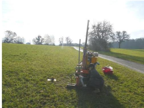
Abb.25: Rammsondierung am Ansatzpunkt DPH 6/17
