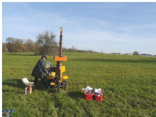
Abb.10: Rammkernsondierung am Ansatzpunkt RKS 6/17
