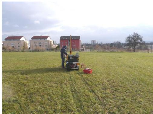
Abb.22: Rammsondierung am Ansatzpunkt DPH 4/17
