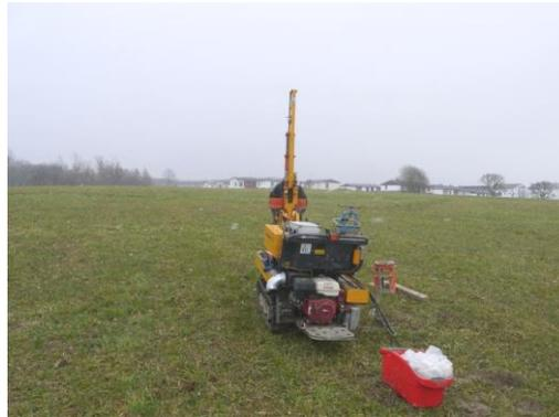
Abb.19: Rammsondierung am Ansatzpunkt DPH 1/17
