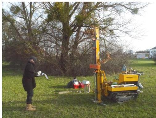
Abb.28: Rammsondierung am Ansatzpunkt DPH 9/17
