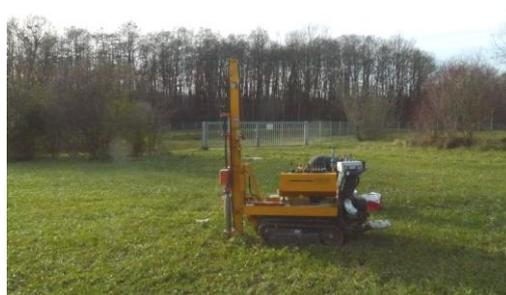
Abb.18: Rammkernsondierung am Ansatzpunkt RKS 12/17
