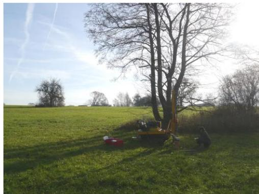
Abb.30: Rammsondierung am Ansatzpunkt DPH 11/17
