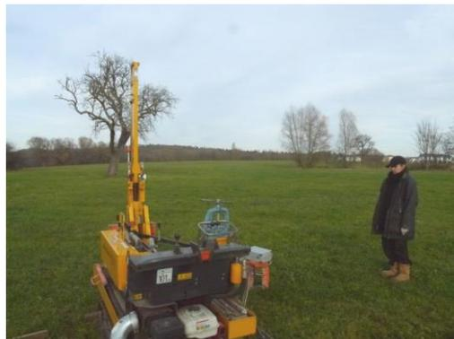
Abb.16: Rammkernsondierung am Ansatzpunkt RKS 10/17
