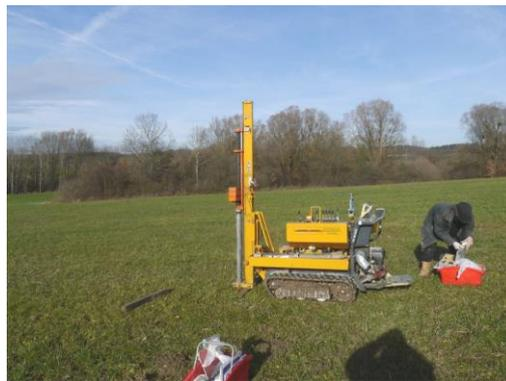
Abb.9: Rammkernsondierung am Ansatzpunkt RKS 5/17
