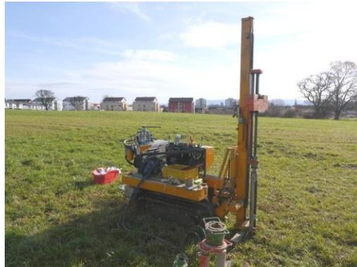
Abb.5: Rammkernsondierung am Ansatzpunkt RKS 2/17
