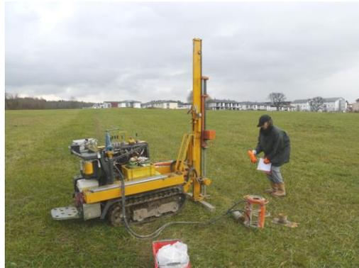
Abb.23: Rammsondierung am Ansatzpunkt DPH 5/17
