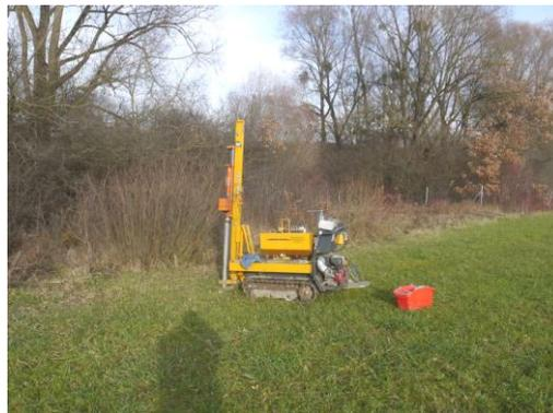
Abb.4: Rammkernsondierung am Ansatzpunkt RKS 1/17
