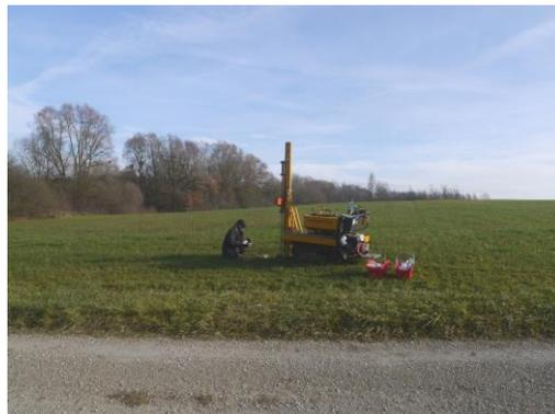
Abb.24: Rammsondierung am Ansatzpunkt DPH 6/17
