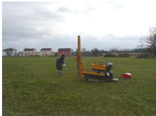
Abb.20: Rammsondierung am Ansatzpunkt DPH 2/17
