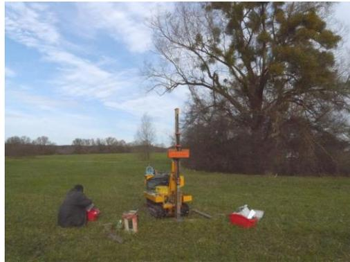
Abb.15: Rammkernsondierung am Ansatzpunkt RKS 9/17
