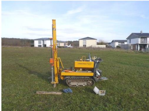
Abb.7: Rammkernsondierung am Ansatzpunkt RKS 3/17
