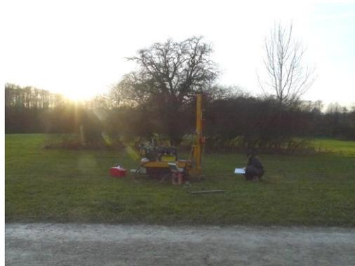
Abb.26: Rammsondierung am Ansatzpunkt DPH 7/17
