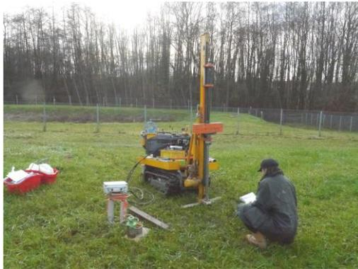
Abb.31: Rammsondierung am Ansatzpunkt DPH 12/17
