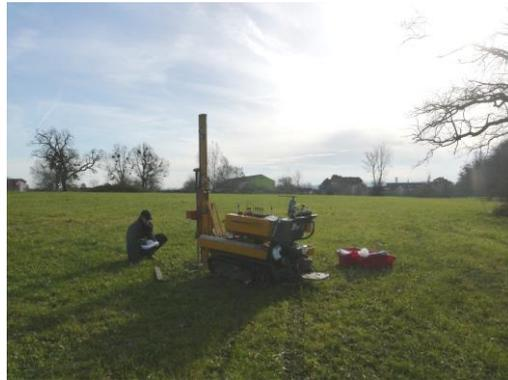
Abb.29: Rammsondierung am Ansatzpunkt DPH 10/17
