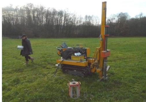
Abb.17: Rammkernsondierung am Ansatzpunkt RKS 11/17
