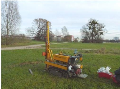
Abb.11: Rammkernsondierung am Ansatzpunkt RKS 7/17
