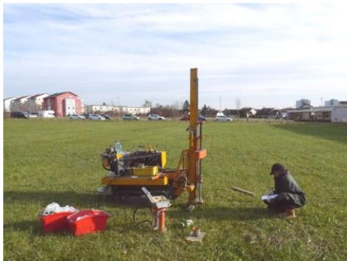
Abb.32: Rammsondierung am Ansatzpunkt DPH 13/17
