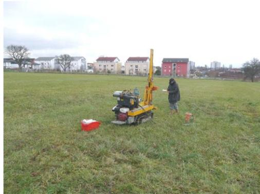
Abb.21: Rammsondierung am Ansatzpunkt DPH 3/17
